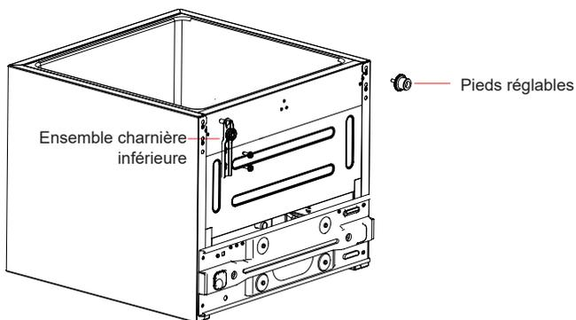
6) Mettez la porte sur la charnière inférieure verticalement, et validez l'étanchéité au gaz du joint de porte, puis installez la charnière supérieure en fixant les vis et le couvercle de la charnière, enfin couvrez les bouchons de trous sur le côté supérieur droit.
