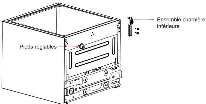
5) Installez la charnière inférieure et le pied réglable sur le côté inférieur gauche de l'armoire et le côté inférieur droit respectivement ;
